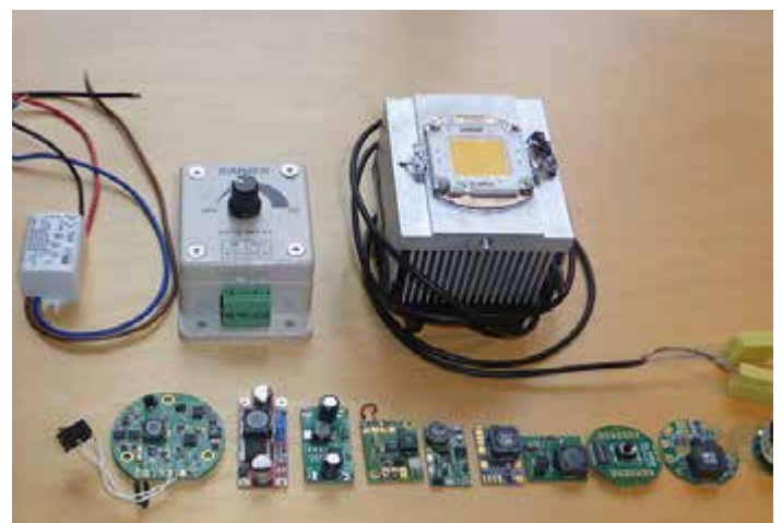
Netzteil für LED, Pulsweitendimmer (12-24V), 100W-LED und diverse regelbare und nicht-regelbare Elektronik
