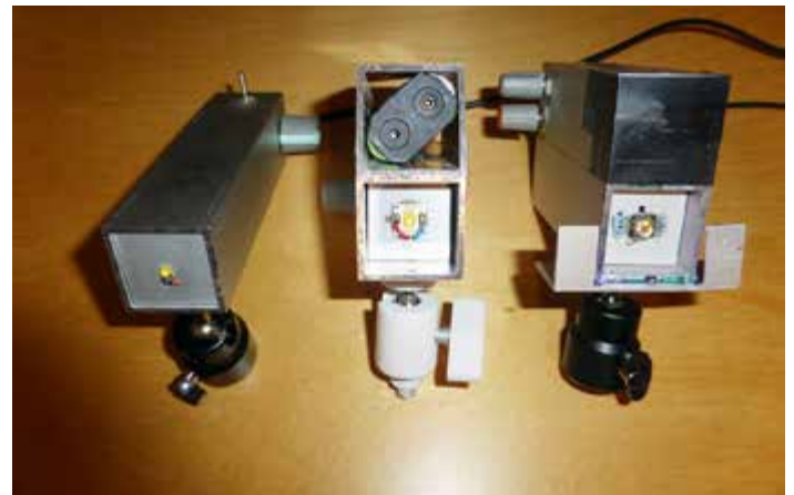
Speziallampen für das Schattentheater (1. mit Netzteil, 2. mit Batterie, alle dimmbar, 3. mit Vierfarb-LED, jede Farbe ist einzeln steuerbar)
